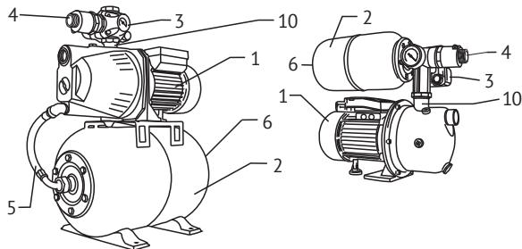
Станция состоит из следующих основных узлов: центробежного поверхностного электронасоса (1), гидроаккумулятора (2), реле давления с манометром (3), датчика потока (4) и соединительного шланга (5) (только для станций с гидроаккумулятором 24 л).
