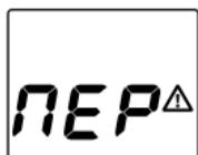
З.У. имеет электронную защиту от переполюсовки. При неправильном подключении З.У. отключается от аккумулятора, на экране замигают надпись “ПЕР” и значок тревоги. После отсоединения клемм З.У. от аккумулятора работоспособность З.У. автоматически восстанавливается.
