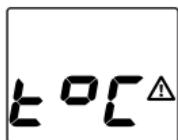
Для защиты силовой части от перегрева применена схема ограничения выходного тока. Эта схема автоматически уменьшает выходной ток при повышении температуры внутри корпуса выше нормы. На экране замигают надпись “ $t^{\circ}\text{C}$ ” и значок тревоги. После уменьшения внутренней температуры источник вернется к обычному функционированию.
