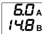
На экране отображается текущий ток и напряжение.
