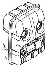
В странах с жарким и сухим климатом вероятность возникновения пожаров очевидна. Поэтому мы оборудуем некоторые глушители т.н. искроулавливающей сеткой. Проверьте, оборудован ли глушитель вашей машины такой сеткой.
