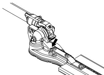
**ВНИМАНИЕ!** Обратите внимание на то, что передача не должна заполняться смазкой полностью. Солидол расширяется при нагревании в результате работы двигателя. Если коробка передач будет полностью заполнена солидолом, появится риск повреждения прокладок и утечки смазки.
