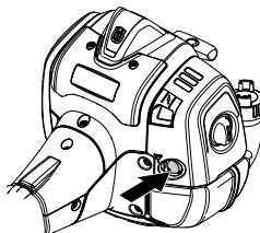
**Заслонка топлива:** Установите заслонку топлива в положение сътнения.
