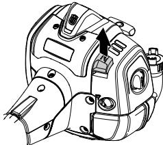
Достать воздушный фильтр, сняв крышку цилиндра. Промыть в чистой, теплой мыльной воде. Перед сборкой удостовериться, что фильтр сухой.
