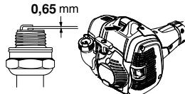
**ВНИМАНИЕ!** Всегда используйте только указанный тип свечи! Применение несоответствующей модели может привести к серьезным повреждениям поршня/цилиндра. Следите за тем, чтобы свеча была оснащена т.н. изоляцией радиопомех.
