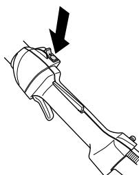
Запустите двигатель и проверьте, чтобы он остановился при переводе выключателя в положение стоп.
