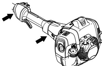
Система виброгашения машины снижает уровень вибрации передаваемый от двигателя или режущего оборудования на рукоятки.
