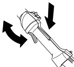
См. указания в разделе Пуск. Запустите ножницы для живой изгороди и откройте полностью газ. Отпустите ручку газа и проверьте, чтобы ножи останавливались и оставались неподвижными. Если ножи врачаются на холостом ходу, отрегулируйте холостой ход карбюратора. См. раздел Техническое обслуживание.
