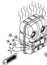
Если на вашем инструменте стоит глушитель такого типа, то сетку следует очищать не реже одного раза в неделю. На глушителях с катализатором, такую очистку достаточно производить раз в месяц. При возникновении повреждений на сетке ее следует заменить. Если сетка часто бывает засорена, значит функция катализатора ухудшена. Обращайтесь к вашему продавцу за советом. Засорение сетки вызовет перегрев двигателя и повреждение цилиндра и поршня.
