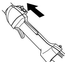
**ВНИМАНИЕ!** Контакт остановки автоматически возвращается в положение запуска. Во избежание непроизвольного запуска, колпачок зажигания следует всегда снимать со свечи зажигания при монтаже, проверке и/или обслуживании.
