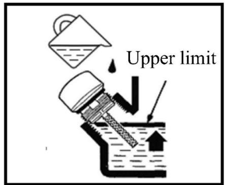
Проверьте уровень масла в картере, опустив щуп в отверстие маслоналивной горловины и не завинчивая крышку выньте его обратно.
