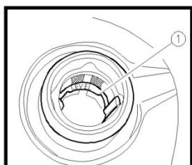
Открутите крышку топливного бака.
