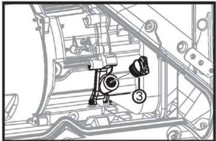
Снимите крышку маслоналивной горловины (3) и промокните масляный щуп куском чистой материи.
