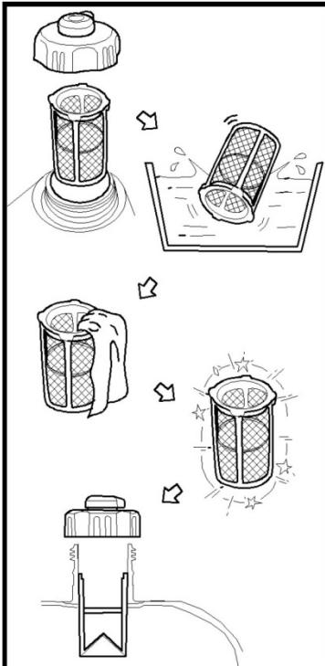
Снимите крышку топливного бака и выньте топливный фильтр грубой очистки.
