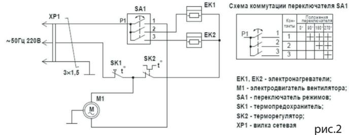
**4.3** Электрическая схема тепловентилятора приведена на рис.2
