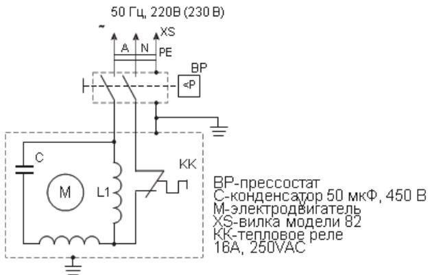
**Схема электрическая принципиальная модель
