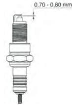
7. Отрегулируйте, при необходимости, аккуратно отогнув боковой электрод. Зазор должен быть: 0.70-0.80 мм (0.028 – 0.031 дюйм)
