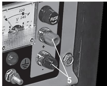
**ПРИМЕЧАНИЕ:** генераторы до 3кВт могут заряжать аккумуляторные батареи
