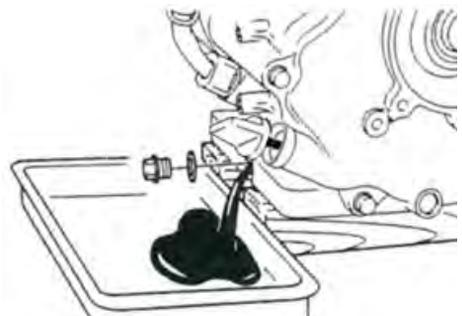
4. Установите обратно уплотнительную шайбу и пробку маслоналивного отверстия (15).
