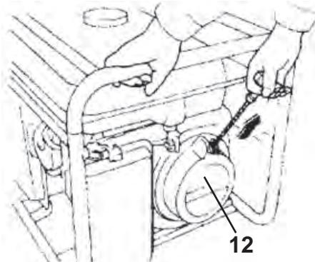
**ПРИМЕЧАНИЕ:** не позволяйте шнуру стартера отскакивать и ударяться ручкой о двигатель.
