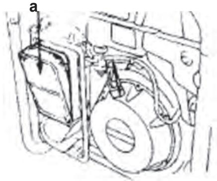
3. Промойте фильтрующий элемент в растворе бытового моющего средства и теплой воды
