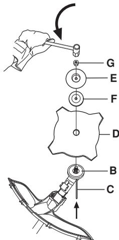
Установка щитка и триммерной головки
