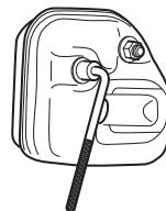
Если глушитель на вашей машине дополнительно оборудован искрогасящим фильтром, его следует регулярно прочищать. Забившийся фильтр может вызвать перегрев двигателя и привести к серьезным повреждениям двигателя.
