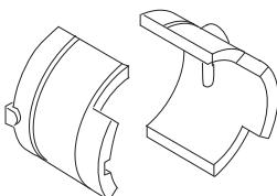
Регулярно проверяйте, чтобы на виброгасящих элементах не было трещин или деформаций.
