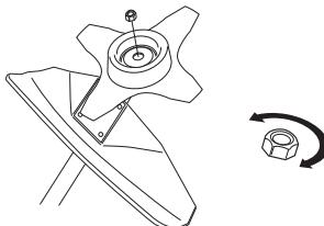
При ослаблении и затягивании гайки лезвия для пиления, рука может быть травмирована зубьями лезвия. Страйтесь, чтобы при этой работе ваша рука всегда была защищена щитком лезвия. Эта задача облегчается за счет использования длинного торцового ключа. На иллюстрации стрелкой показан участок, в котором следует располагать торцовый ключ при ослаблении и затягивании гайки.
