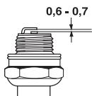
**ВНИМАНИЕ!** Всегда используйте только указанный тип свечи! Применение несоответствующей модели может привести к серьезным повреждениям поршня/цилиндра. Следите за тем, чтобы свеча была оснащена т.н. изоляцией радиопомех.
