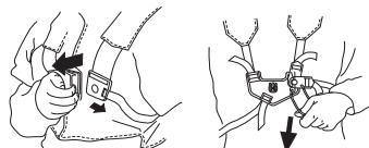
Удостоверьтесь, что привязные ремни оснастки были правильно расположены. Когда машина будет отрегулирована, проверьте работу системы быстрого отстегивания оснастки.
