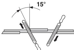
Отрегулируйте разводку. Она должна составлять 1 мм.
