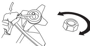
Нейлоновая прокладка контргайки не должна быть изношена настолько, чтобы ее можно было поворачивать вручную. Прокладка должна выдерживать усилие минимум 1,5 Нм. Гайку следует заменить после ее использования приблизительно 10 раз.
