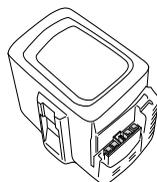
Направляющие аккумуляторной батареи должны быть очищены от грязи. Очистите пластмассовые детали чистой и сухой тканью.
