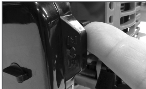
Рис.9 Закрытие воздушной заслонки
