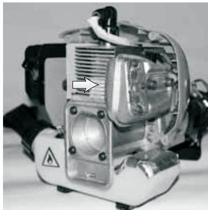
Грязные ребра цилиндра двигателя могут стать причиной его перегрева и поломки. Регулярно очищайте от загрязнений ребра цилиндров кисточкой и/или сжатым воздухом. В зависимости от использования триммера необходимо чистить искрогаситель двигателя. Загрязненный искрогаситель может отрицательно сказаться на мощности двигателя и качестве покоса.
