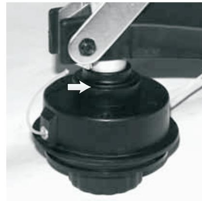
Регулярно производите осмотр и чистку крепления триммерной катушки к нижней штанге триммера. В месте крепления не должно находиться скошенной травы и иных загрязнений. Загрязненное крепление может стать причиной перегрева и выхода из строя катушки триммера.
