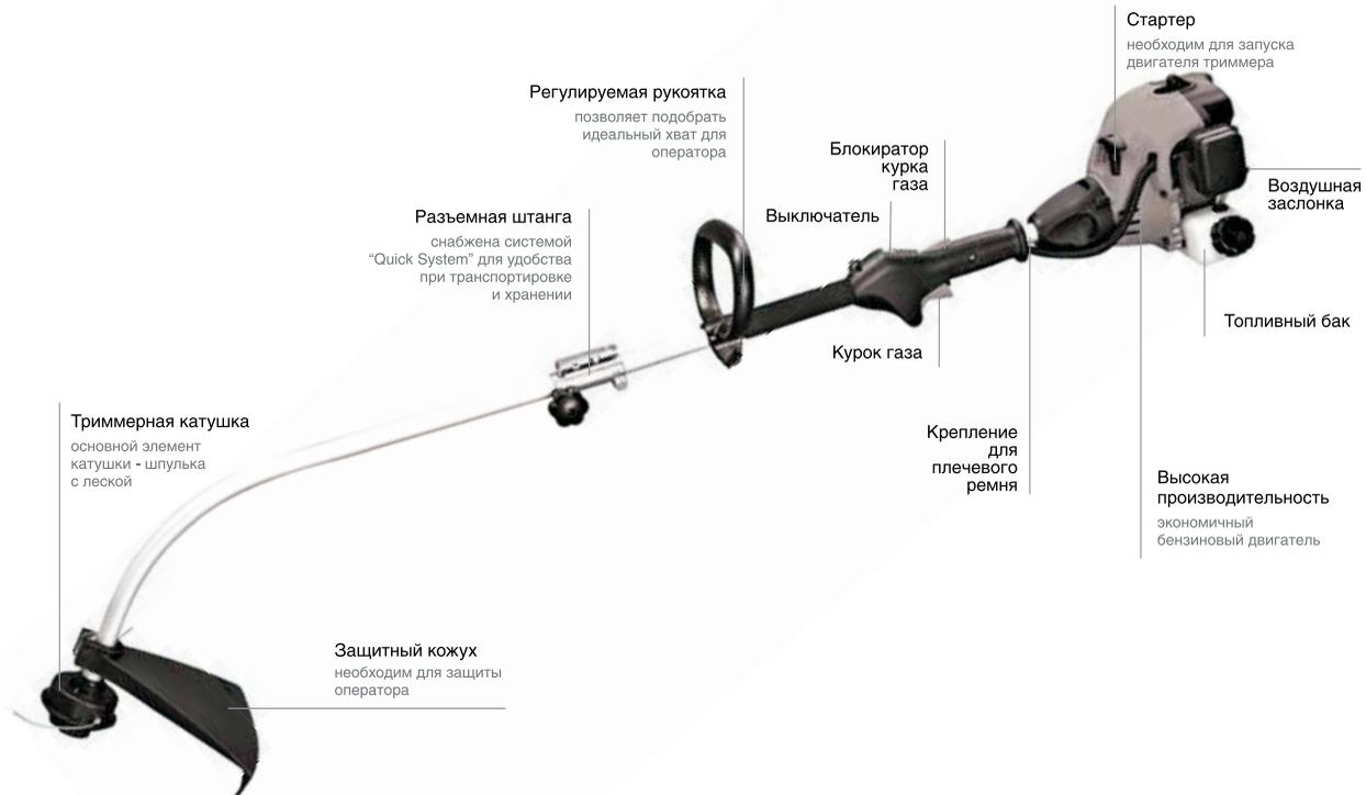
КОНСТРУКЦИЯ И ВНЕШНИЙ ВИД ТРИММЕРА МОГУТ ОТЛИЧАТЬСЯ ОТ ПРИВЕДЕННОЙ В ИНСТРУКЦИИ
