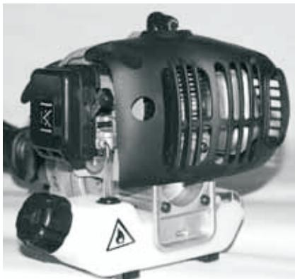
При загрязнении охлаждающих отверстий продуктами покоса и масляным шламом используйте для очистки кисточку и/или баллон со сжатым воздухом.
