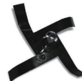
Дополнительная фреза необходима для увеличения ширины вспахивания
