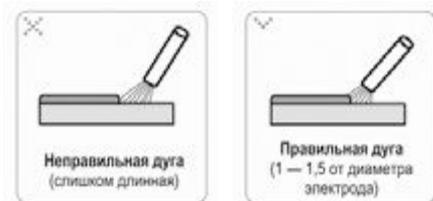
Очень важно, чтобы длина дуги была правильной, т.к. это влияет на сварочный ток и напряжение. Непрочный сварочный шов является результатом неправильного тока сварки. Наклон
