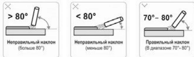
электрода (вперед) должен составлять  $70^\circ$  или  $80^\circ$ . При слишком большом наклоне сварочный шов может стать пористым.
