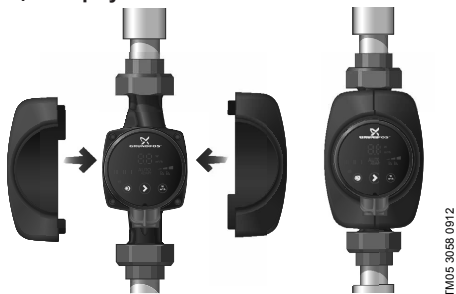
Рис. 8 Изоляция корпуса насоса
