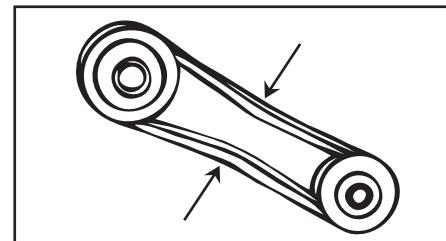
▶ нажмите на ремень посередине между шкивами. Прогиб должен составлять не более 10–15 мм. Если прогиб отличается от указанного, измените натяжение ремня, для чего отпустите болты крепления оси диска и перемещением оси обеспечьте правильное натяжение ремня. Затяните болты оси диска;
