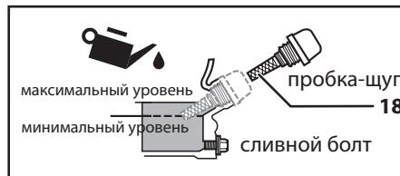
▶ проверьте наличие масла в картере двигателя, сняв пробку (с щупом) 18 горловины заправки масла. При наличии следов масла на щупе, проверьте уровень масла в картере: протрите щуп чистой сухой ветошью, установите щуп на место и снова выньте. Если уровень масла достаточен (между минимальной и максимальной метками щупа), доливать масло не следует;
