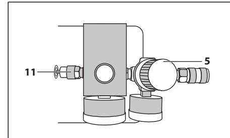
Перед началом работы отключите подачу давления, закрутив регулятор давления **5**.
