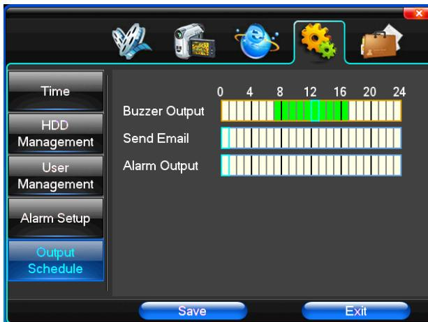
【Buzzer Output】 Интервал времени в котором будет срабатывать звонок при тревоге.
