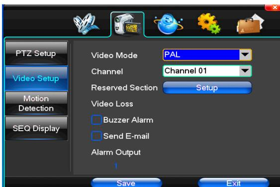
【Video Mode】 Предоставляется на выбор два режима видео: PAL и NTSC, изменения вступят в силу только после перезагрузки системы.
