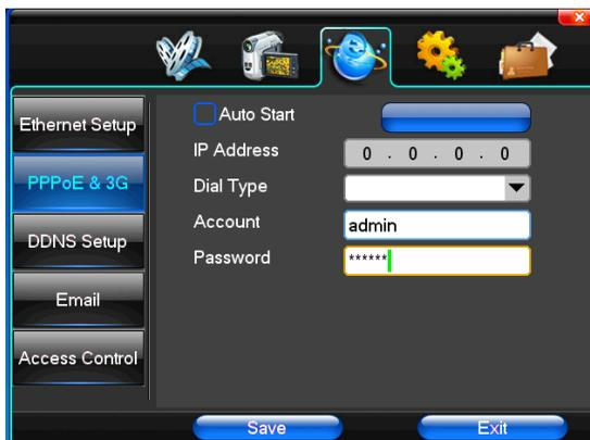
**Примечание:** При успешной установке PPPoE соединения, обратитесь к пункту **【PPPoE IP】** для получения IP адреса.
