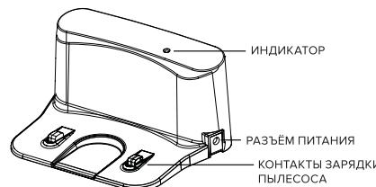
Используется роботом-пылесосом в качестве зарядной базы при завершении уборки или в случае низкого заряда аккумулятора. Робот-пылесос самостоятельно обнаруживает станцию, реагируя на инфракрасный сигнал базы.
