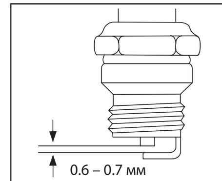
При замене используйте соответствующие свечи зажигания (Е6ТС или аналогичные).
