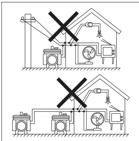
Подключение необходимо выполнять **ТОЛЬКО** через коммутационное устройство (например, двухполюсный переключатель), исключающее одновременное подключение к нагрузке обоих источников.
