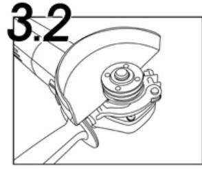
Установите защитный кожух так, чтобы исключался выброс искр в направление оператора.
