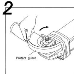
**Вариант В.** Имеется рычаг блокировки кожуха.
