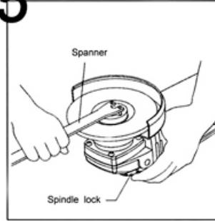
**ВНИМАНИЕ!** Кнопка стопорного вала используется только для установки и демонтажа диска. Не используйте ее в качестве аварийной кнопки, когда работает электроинструмент. В противном случае это может привести к поломке инструмента или нанесению телесных повреждений.
