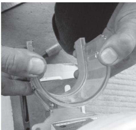
Закрепите кожух при помощи винтов.
