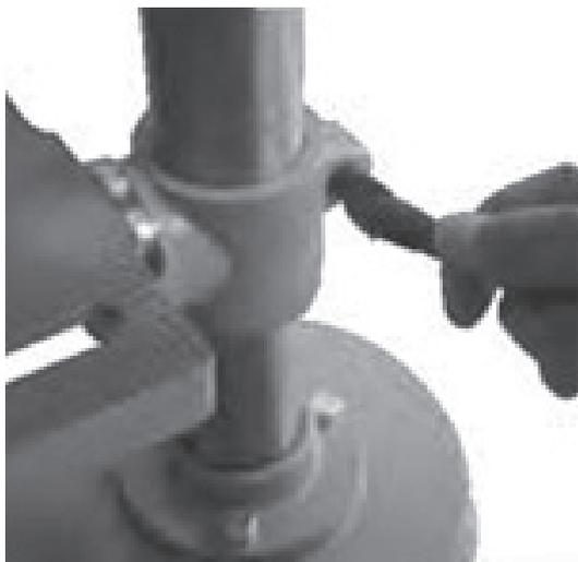
При сверлении заготовок больших размеров рабочий стол можно повернуть в любую сторону на 180 градусов и разместить заготовку на основании. Для этого ослабьте рукоятку настройки положения рабочего стола (10), поверните рабочий стол в нужное положение и вновь затяните рукоятку.
