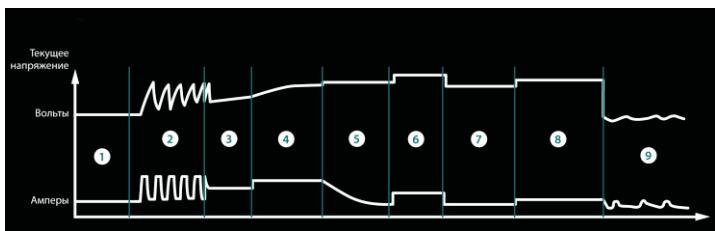
**1. Тест батареи.** Проверка напряжения аккумуляторной батареи, правильности подключения батареи и состояния батареи (рабочая или повреждена) перед началом процесса зарядки.
