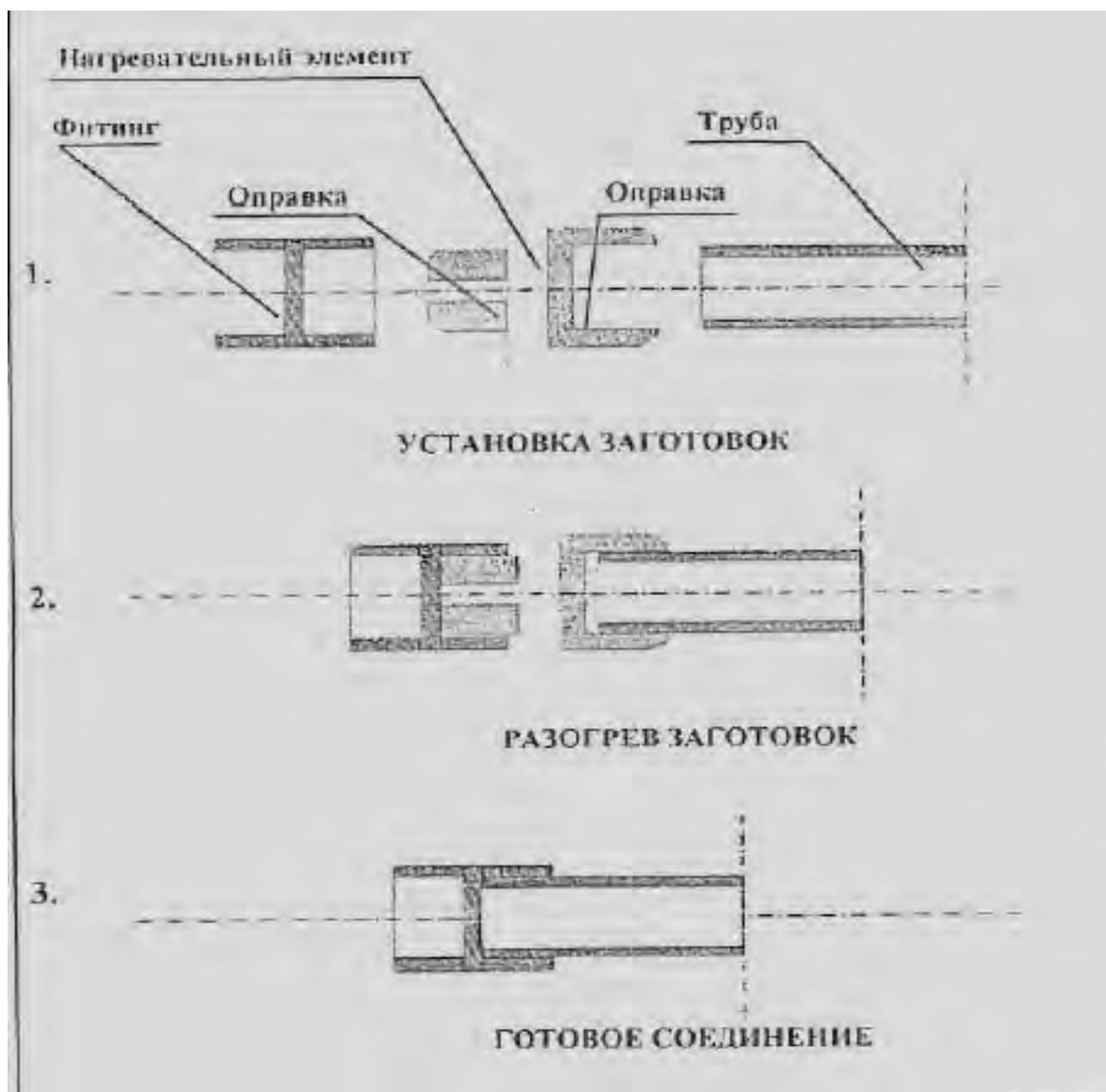
1. **Нагрев** - одновременная установка раструба фасонной детали (фитинга) и гладкого конца трубы в соответствующие оправки сварочной насадки до упора и прогрев их в течение времени (Время нагрева).
