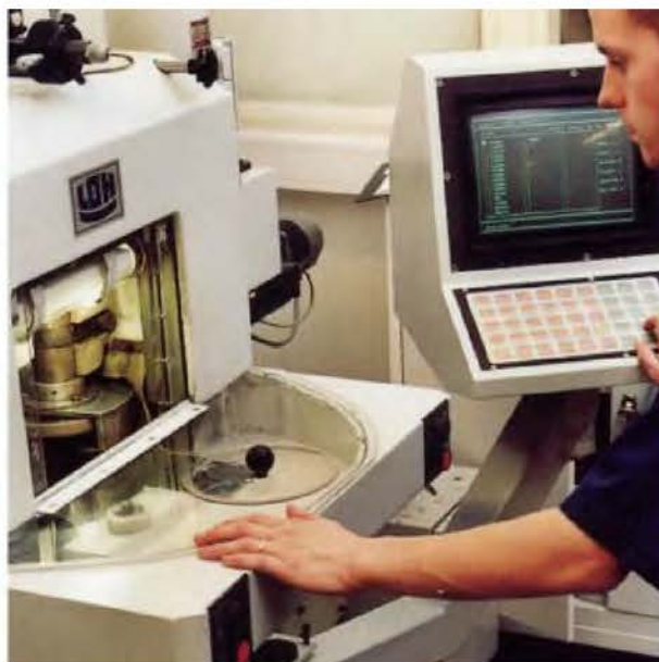
Рисунок 29.4 СЛЕВА: Алмазно-токарный механизм; СПРАВА: Полирование линз
