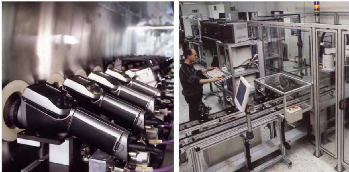
Рисунок 29.5 СЛЕВА: Тестирование инфракрасных камер в климатической камере; СПРАВА: Робот для тестирования и калибровки камеры
