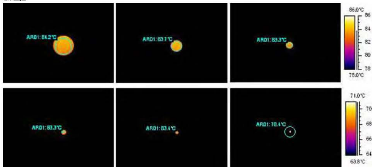
Рисунок 28.20 Измеренная температура абсолютно черного тела при температуре +85°C для возрастающих значений расстояния (объектив 24°)
