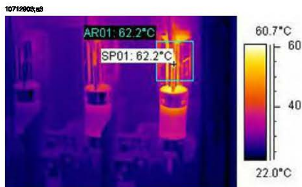
Рисунок 28.3 ИК-изображение блока предохранителей с указанием значения максимальной температуры
