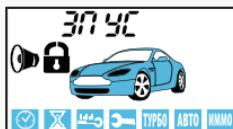
затем - индикация работающего двигателя, режима включенной охраны и оставшегося времени прогрева двигателя (r10, r20 или r30):
