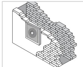
Для монтажа с воздуховодами  $\varnothing 100, 120, 150$  мм и квадратными отверстиями соответствующих размеров.
