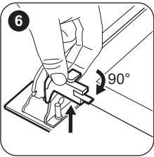
**6** Поверніть два фіксатори на 90° і вийміть їх із гнізд.
