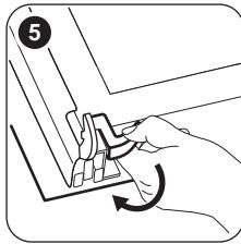
**5** Вивільніть систему блокування для того, щоб витягнути внутрішню скляну панель.
