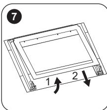
**7** Сначала осторожно поднимите и выньте стеклянную панель.
