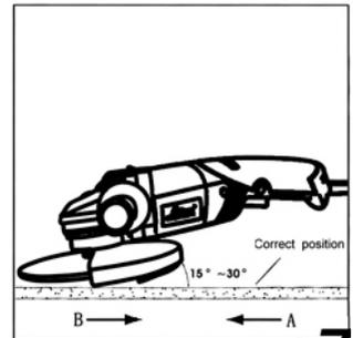
**ПРИМЕЧАНИЕ:** Подготовьтесь к сильному искрению, которое появляется в момент касания диском металла. Во время шлифования постоянно держите правильный угол между шлифовальным диском и рабочей поверхностью. Благодаря этому достигается оптимальный результат и предупреждается перегрузка машины.
