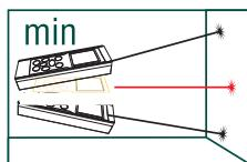
Режим непрерывных измерений незаменим при монтаже и разметке. Также применяется для поиска минимального расстояния между объектами (трекинг).
