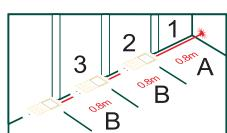
Режим измерения отрезков позволяет просто и быстро отмерить заданное расстояние необходимое количество раз.
