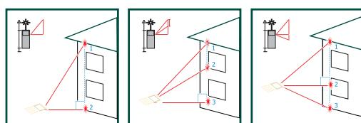
Режим косвенных измерений (вычисление неизвестного катета) позволяет измерять расстояния между точками, а также размеры объектов без непосредственного доступа к ним. Возможность складывать и вычитать полученные отрезки.
