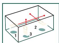
Режим вычисления площади и объема. Две встроенные программы автоматического вычисления.
