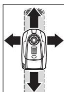
Установите измерительный инструмент на обследуемую поверхность и передвигайте его в сторону. Если кольцо **1** продолжает светиться зеленым светом и не раздается звуковой сигнал, то в основании не обнаруживается никакой металлический объект. При приближении измерительного инструмента к металлическому объекту индикатор все явнее показывает металлический объект **c**. Над металлическим объектом кольцо **1** светится красным светом и раздается звуковой сигнал.
