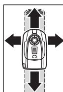
Przyłożyć urządzenie pomiarowe do przeszukiwanej powierzchni i przesuwać je na boki. Jeżeli dioda **1** świeci w dalszym ciągu na zielono i nie jest słyszalny sygnał dźwiękowy, oznacza to, że w podłożu nie został rozpoznany żaden obiekt metalowy.
