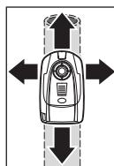
Namestite merilno orodje na površino, ki jo želite pregledati in ga stransko premikajte. Če prstan **1** tudi nadalje sveti zeleno in ne zaslišite signalnega zvoka, potem v podlagi ni razpoznavnega kovinskega objekta. Če se merilno orodje približuje kovinskemu objektu, potem se povečuje odklon prikaza meritve **c**. Če se pomakne preko kovinskega objekta, potem prstan **1** zasveti rdeče ter zadoni signalni zvok.
