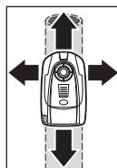
Položte měřící přístroj na prohledávanou plochu a bočně jím pohybujte. Svítí-li kroužek **1** nadále zeleně a nezazní žádný signální tón, není v podkladu rozpoznatelný žádný kovový objekt. Blíží-li se měřící přístroj ke kovovému objektu, vzrůstá výchylka na ukazateli měření **c**. Nad kovovým objektem je kroužek **1** červený a zazní signální tón.
