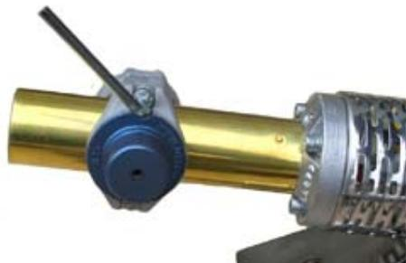
Т.н. колодочные насадки предназначены для стержневых аппаратов. Они идеальны для сварки в условиях ограниченного доступа. Диапазон стандартных диаметров колодочных насадок для раструбной сварки 16–63 мм. В качестве опции поставляется колодочная насадка Plate100 с плоскими рабочими поверхностями, она предназначена для стыковой сварки труб до Ø90мм в неотвественных местах.
