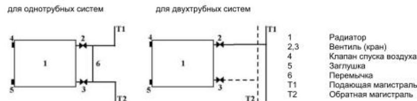
**Установка любой запорно-регулирующей арматуры на замыкающих участках (перемычках) в однотрубных системах запрещена! В тех случаях, когда запорная арматура устанавливается на обоих подводах к алюминиевому радиатору, во избежание аварийной ситуации не допускается полное перекрытие заполненного водой радиатора без обязательного в этом случае открытия воздухоотводчика!**
