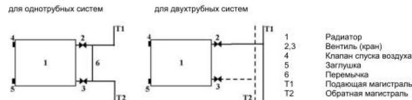
**Установка любой запорно-регулирующей арматуры на замыкающих участках (перемычках) в однотрубных системах запрещена! В тех случаях, когда запорная арматура устанавливается на обоих подводах к биметаллическому радиатору, во избежание аварийной ситуации не допускается полное перекрытие заполненного водой радиатора без обязательного в этом случае открытия воздухоотводчика!**
