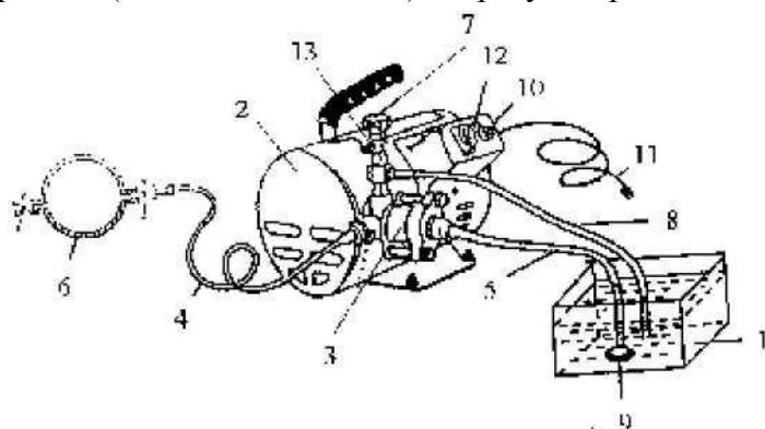
клапана давления 13, всасывающего шланга 5 с фильтром 9 и дренажного шланга 8.
