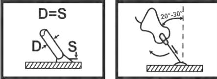
Завершая процесс сварки, следует правильно заварить кратер, который образуется в процессе сварочных работ от контакта электрода со свариваемой поверхностью. Это необходимо сделать во избежание возможного возникновения трещин в сварочном шве. Не следует обрывать дугу, резко отводя электрод от изделия. Необходимо прекратить все перемещения электрода и медленно удлинять дугу до обрыва; расплавляющийся при этом электродный металл заполнит кратер.
