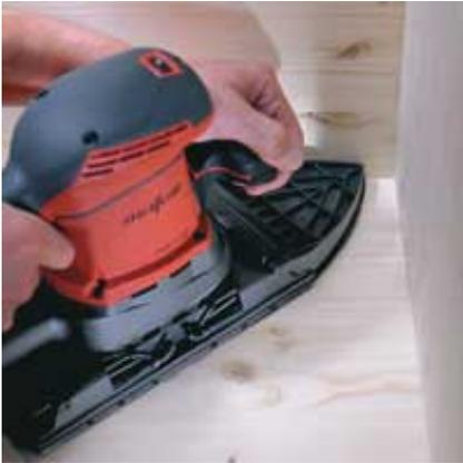
Будь то в углах, или на краях, или в других затруднённых местах – когда требуется высокое качество шлифование - с лёгкостью обеспечивает трёх угольная подошва Delta.
