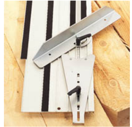
...так и в лево на стропиле и паз фрезеруется по направляющей системе.
