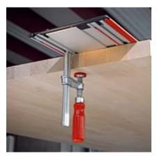
С помощью струбцины направляющая шина прочно крепится на заготовке.
