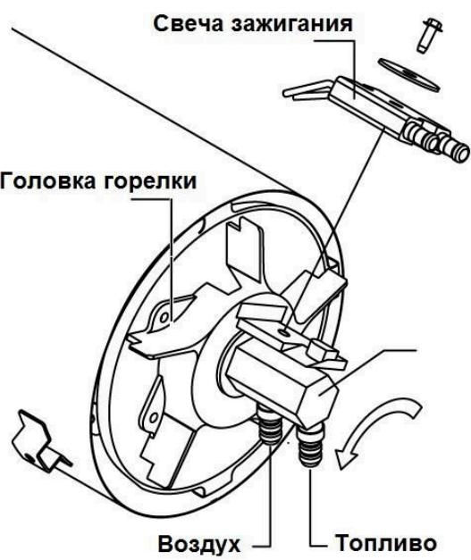
7.5. Снимите свечу как описано в пункте 7.5. Очистите электроды свечи от нагара и отрегулируйте зазор, который должен быть 3,5 мм. Соберите нагреватель в обратном порядке.
