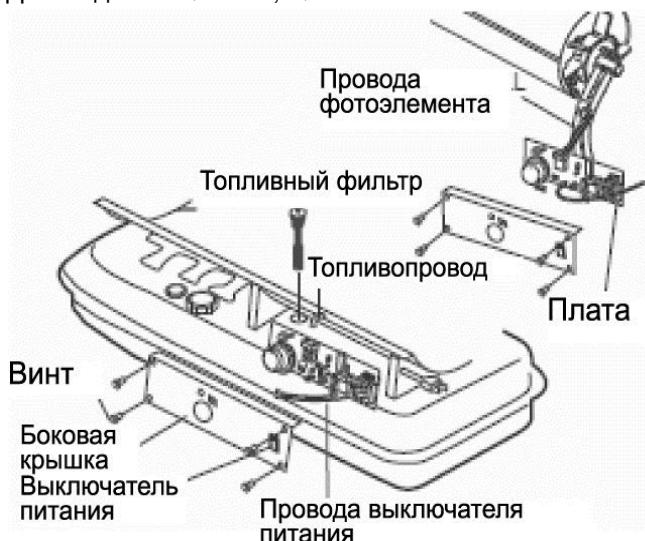
Снять боковую крышку, отсоединить топливопровод от топливного фильтра. Повернуть топливный фильтр против часовой стрелки на 90°, потянуть его на себя и вынуть. Промыть фильтр керосином и установить обратно. Присоединить топливопровод и установить обратно боковую крышку.
