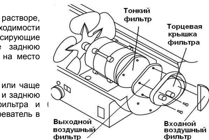
Очищать по мере необходимости, но не реже 1 раза в год. Снимите верхний кожух. Ослабьте винт, удерживающий лопасти на валу и снимите лопасти. Очистите лопасти вентилятора мягкой тканью смоченной в керосине или растворителе. Просушите лопасти и установите обратно на вал. Закрутите плотно винт, установите верхний кожух. При несвоевременной очистке лопастей, появляется дисбаланс вентилятора, что приводит его к выходу из строя.
