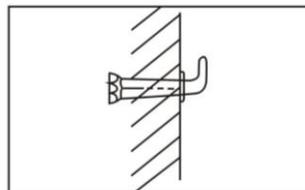
в) Подвесьте водонагреватель за кронштейн корпуса на крюки анкерных болтов. Убедитесь в том, что нагреватель надежно закреплен.
