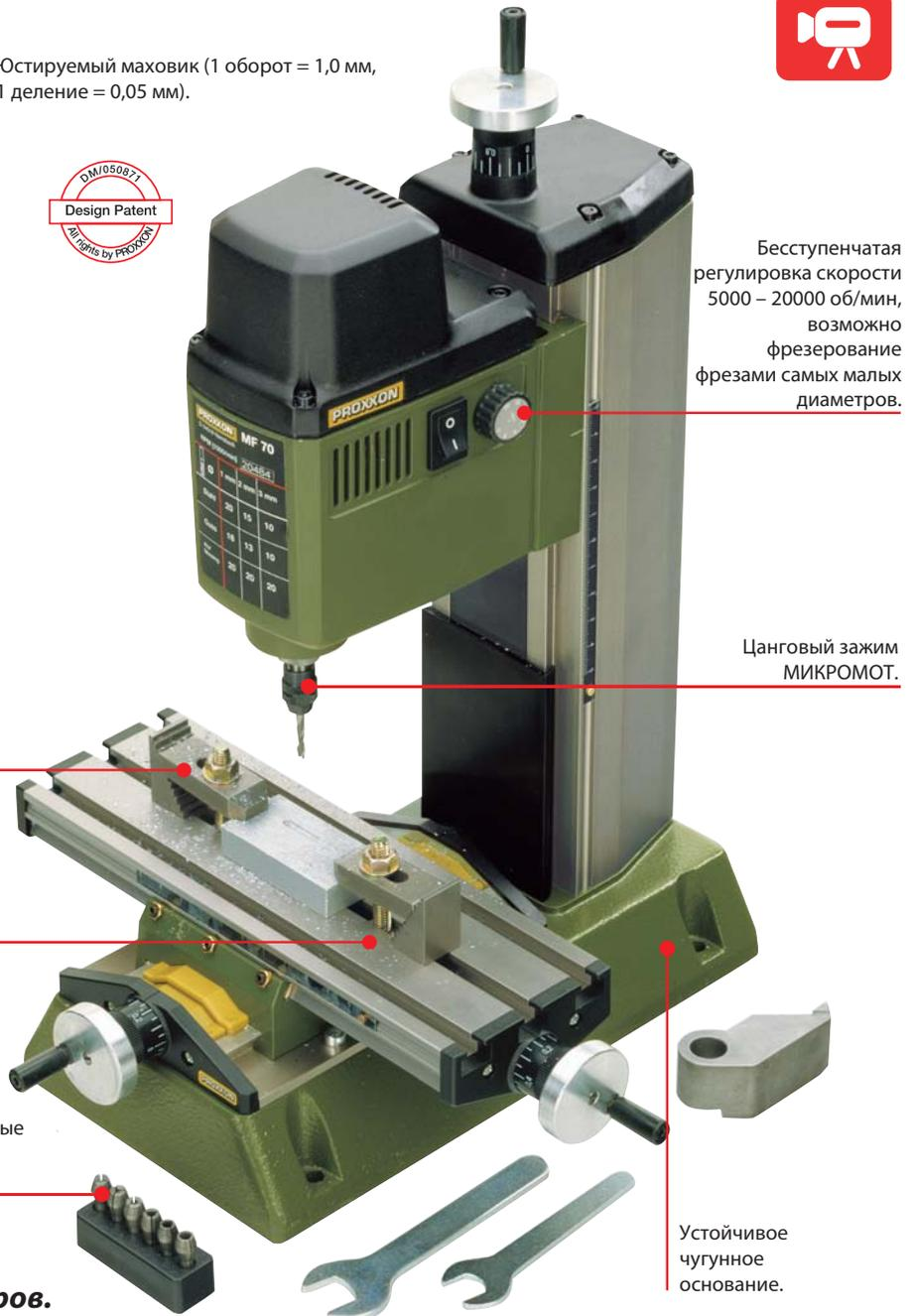
Бесступенчатая регулировка скорости 5000 – 20000 об/мин, возможно фрезерование фрезами самых малых диаметров.
