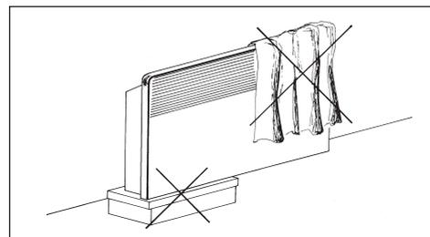
Во избежание перегрева конвектора ни в коем случае ничем не накрывать прибор. Как и в других подобных обогревателях, поток поднимающегося воздуха может стать причиной обесцвечивания стены.
