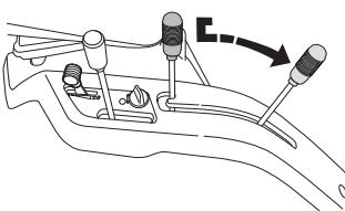
Этот рычаг можно также использовать для временного регулирования высоты резки, например на небольшом бугре на газоне.
