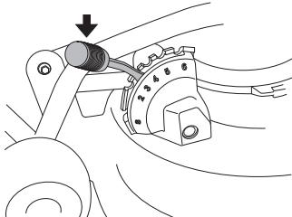
Чтобы высота стрижки была ровной, важно, чтобы давление воздуха в шинах было одинаковым на обеих передних колесах 60 кПа / 0,6 bar/8,5 PSI.
