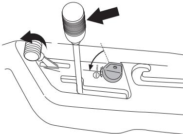
Для райдера 111B Потяните ручку газа назад и поверните ключ зажигания в положение 'STOP'.
