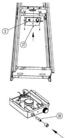
5. Установите батарею AA(20) в блок управления, затем прикрутите блок управления(2) под центральную пластину(1) при помощи винтов(17)
