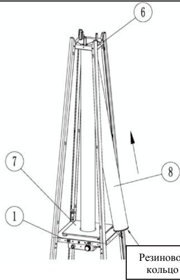
6. Осторожно введите стеклянную трубку (8) вверх через центральное отверстие в верхней пластине(6), Убедитесь, что резиновое кольцо прикреплено к нижнему концу стеклянной трубы(8). Подвиньте и установите стеклянную трубку(8) через отверстие в крышке(7) на средней пластине(1), убедитесь, что стеклянная трубка(8) закрывает центральное отверстие в центральной пластине(1).
