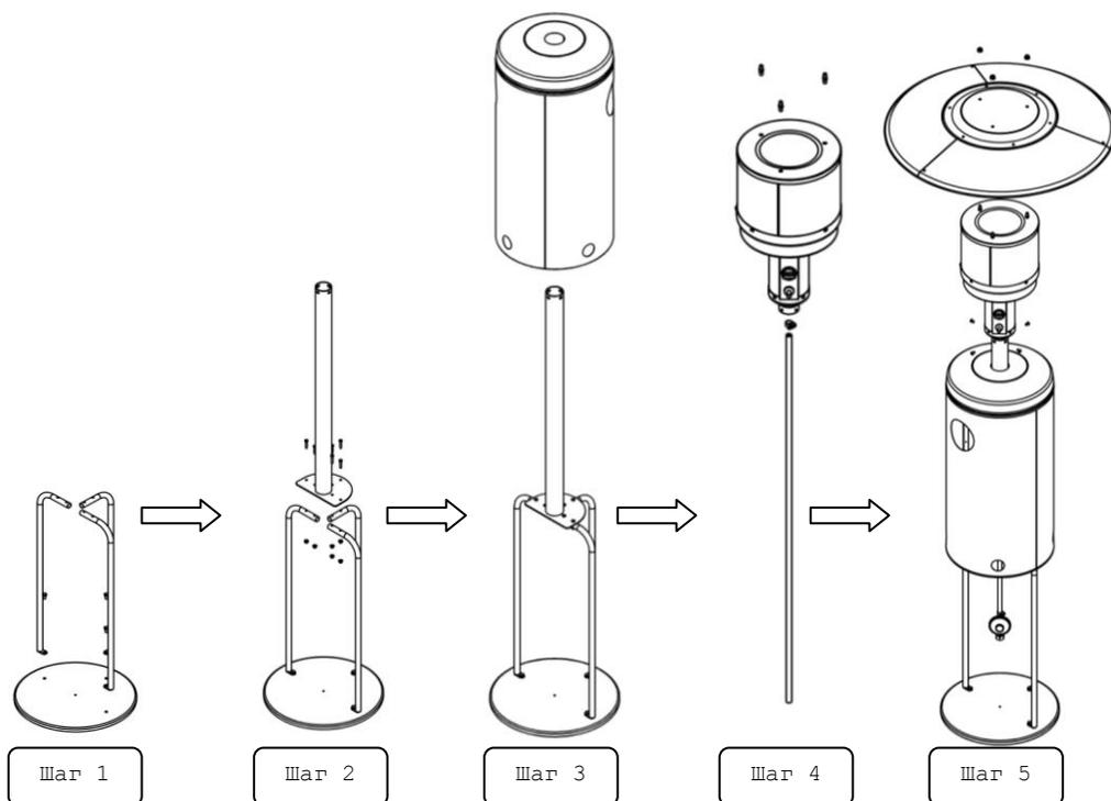
Обогреватель готов к подсоединению газового баллона.
