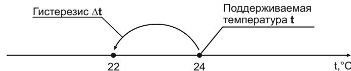
При этом нагреватель, управляемый терморегулятором, будет нагревать помещение до  $24^\circ\text{C}$  и отключаться. После остывания помещения на  $2^\circ\text{C}$  (до  $22^\circ\text{C}$ ), терморегулятор снова включит нагреватель и цикл повторится.
