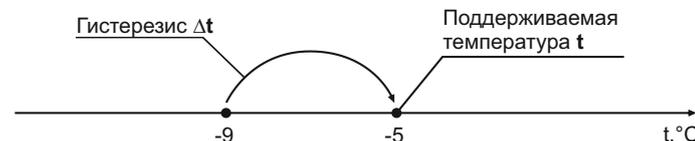
При этом охлаждающий элемент, управляемый терморегулятором, будет охлаждать морозильную камеру до  $-9^\circ\text{C}$  и отключаться. После повышения в ней температуры на  $4^\circ\text{C}$ , т.е. до  $-5^\circ\text{C}$ , терморегулятор снова включит охлаждающий элемент, начнется охлаждение и цикл повторится.
