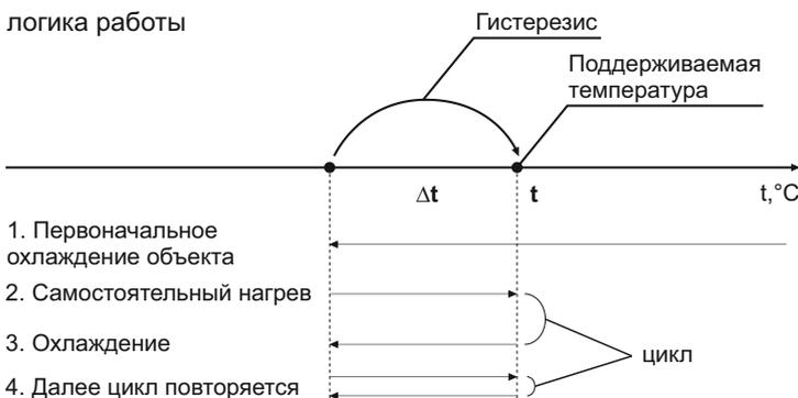
Гистерезис - это разница между температурой включения и отключения контактов реле терморегулятора (падение температуры).
