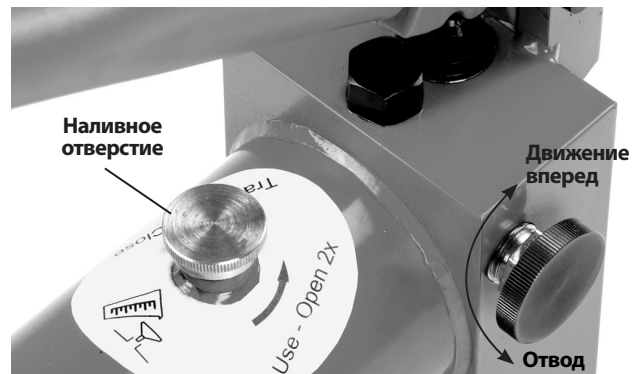
Рис.10 – Положения маховичка (вывод/отвод)
