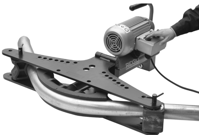
Рис.14 - Работа на электрической гибочной машине
