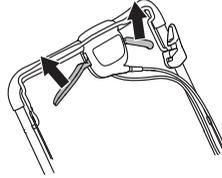
Якщо відчувається, що привід працює повільно, треба відрегулювати дріт зчеплення. Для регулювання дроту використовуйте гвинт регулювання.
