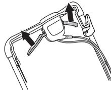
Cuando la transmisión comience a ralentizarse, será necesario ajustar el cable del embrague. Use el tornillo de ajuste para llevar a cabo el reglaje preciso del cable.
