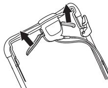
Když se pohon začne zpomalovat, seřídte lanko ovládání spojky. Jemně seřídte lanko pomocí seřizovacího šroubu.
