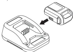
**ЗАПОМНЕТЕ!** Акумулаторът на този модел е компонент за безопасност. Използвайте само оригинални резервни части.
