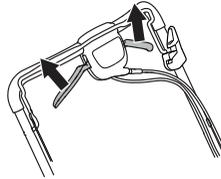
Kun veto alkaa tuntua hitaalta, kytkinvajeria on säädettävä. Säädä hieman johtoa säätöruuvilla.
