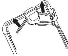
Σε περίπτωση επιβράδυνσης του συστήματος μετάδοσης κίνησης, προσαρμόστε τη ντίζα του συμπλέκτη. Τέλος, ρυθμίστε το καλώδιο με τη βίδα ρύθμιση.
