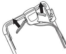
Haben Sie das Gefühl, dass der Antrieb langsam voran geht, muss das Kupplungsseil angepasst werden. Nehmen Sie die Feineinstellung des Drahts mithilfe einer Stellschraube vor.
