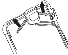
Lorsque l'entraînement ralentit, vous devez régler le câble d'embrayage. Réglez avec précision le câble à l'aide de la vis de réglage.
