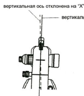
Теодолит оснащен компенсатором вертикальной оси уклона. Прибор имеет функцию самовыравнивания угла наклона. Когда датчик уклона включен, прибор может отображать угол уклона вертикальной оси. Вы можете выровнять прибор вручную. Когда угол уклона выходит за диапазон самовыравнивания, на дисплее отображается "TILT". Необходимо выровнять прибор.
