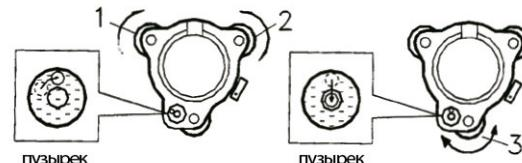
**1.4. Выровняйте инструмент цилиндрическим уровнем**
